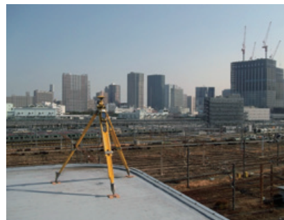
公共基準点のGNSS測量(人工衛星を使用した測量)の様子
